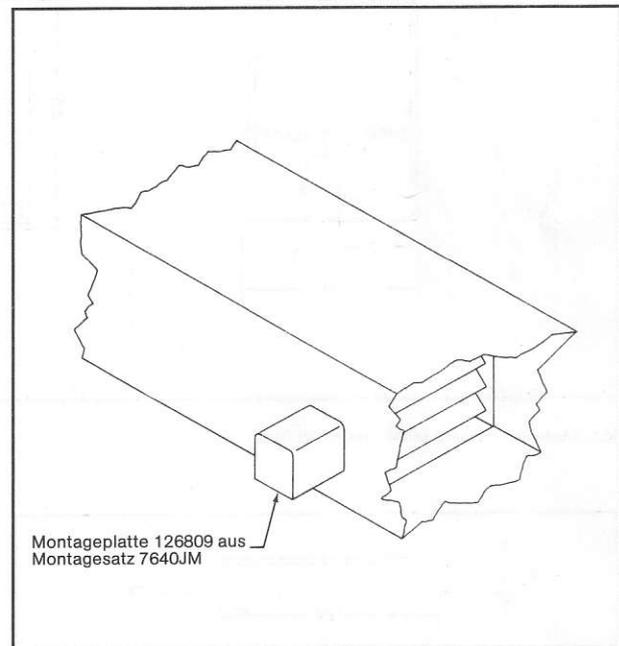
Bild 8 Elektromotorischer Stellantrieb direkt mit den Jalousieklappen gekoppelt. Verwendet wird der Zubehörsatz 7640JM und der Zubehörsatz 7640JE.
