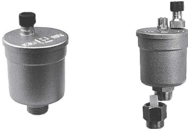
MINIVENT-automatischer Schnellentlüfter für geschlossene Warm- und Kaltwasseranlagen mit Temperaturen bis 115°C und Drücken bis 12 bar. Selbsttätiges Ent- und Belüften der Anlage beim Füllen, Entleeren und im Betrieb.
