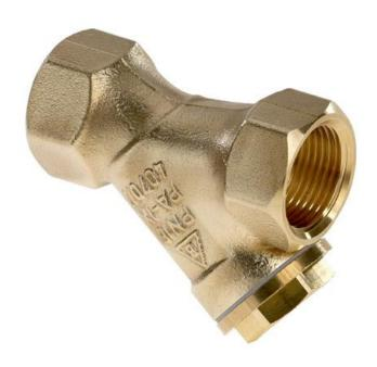
Schmutzfänger mit Niro-Feinfilter Maschenweite 0,25mm, mit PTFE-Dichtung (Teflon)
